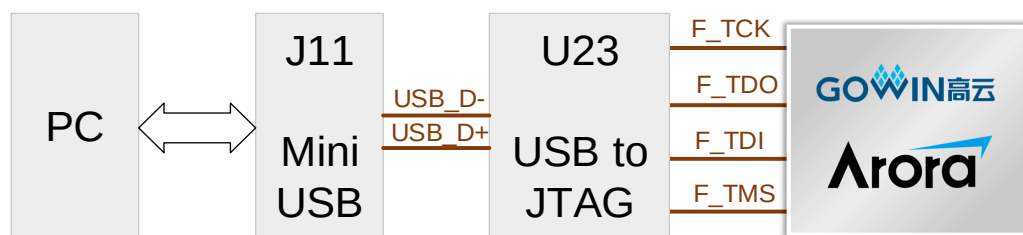
図 3-2 ダウンロード・インターフェースの接続図
