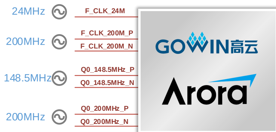
図 3-3 クロックの接続図
