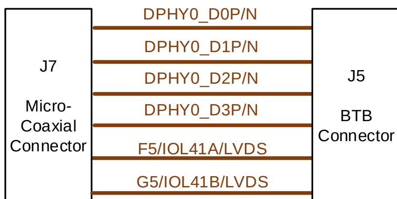
図 4-9 MIPI DPHY ハードコア・インターフェースの接続図
