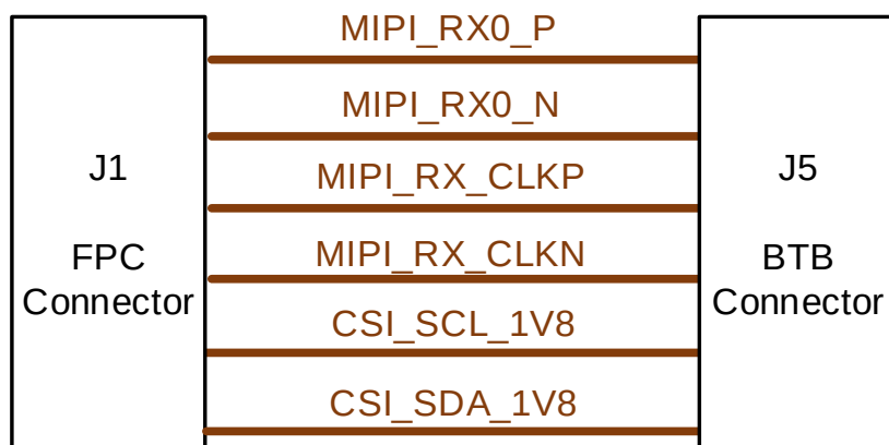
図 4-10 MIPI DPHY ソフトコア・インターフェースの接続図
