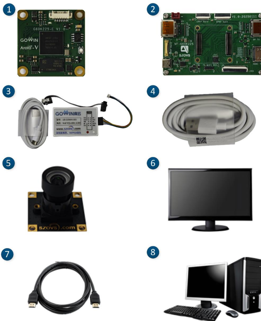
図 4-5 SC2210 カラー1 レーン HDMI ディスプレイ表示プロジェクトのハードウェア・コンポーネント
