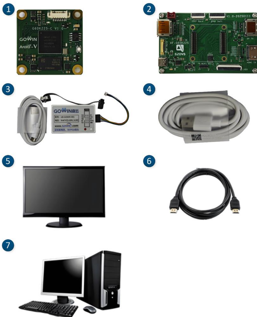
図 3-7 1920*1080@60 HDMI ディスプレイ表示実験のハードウェア・コンポーネント
