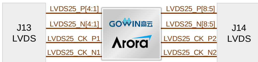
図 3-12 LVDS インターフェースの接続図
