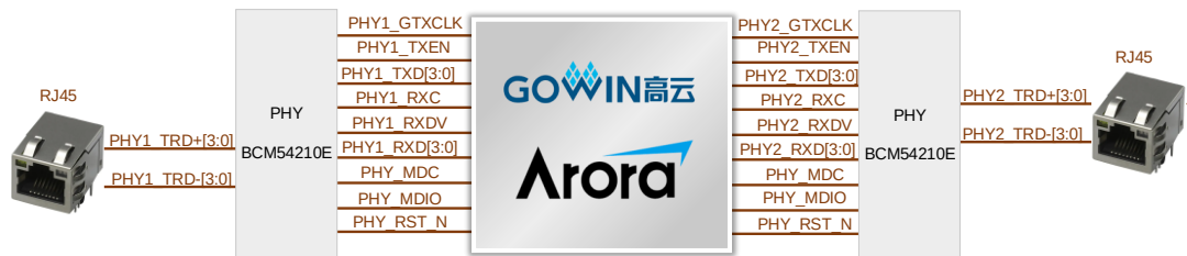
図 3-10 イーサネット・インターフェースの接続図
