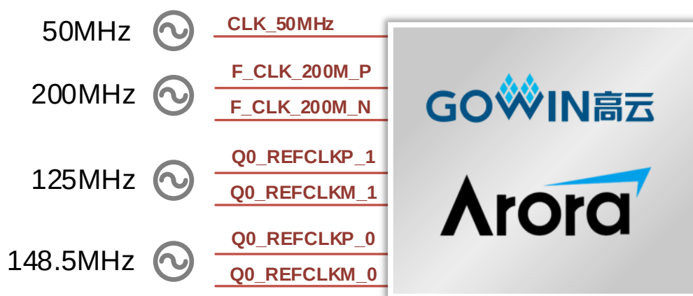
図 3-3 クロックの接続図
