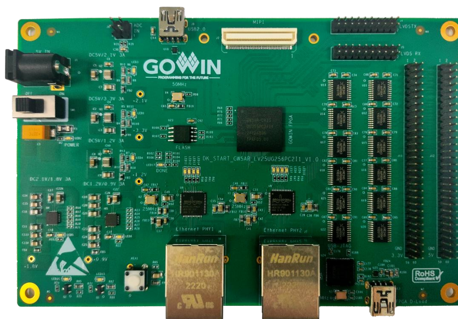
図 2-1 DK_START_GW5AR-LV25UG256PC2I1_V1.0 開発ボード
