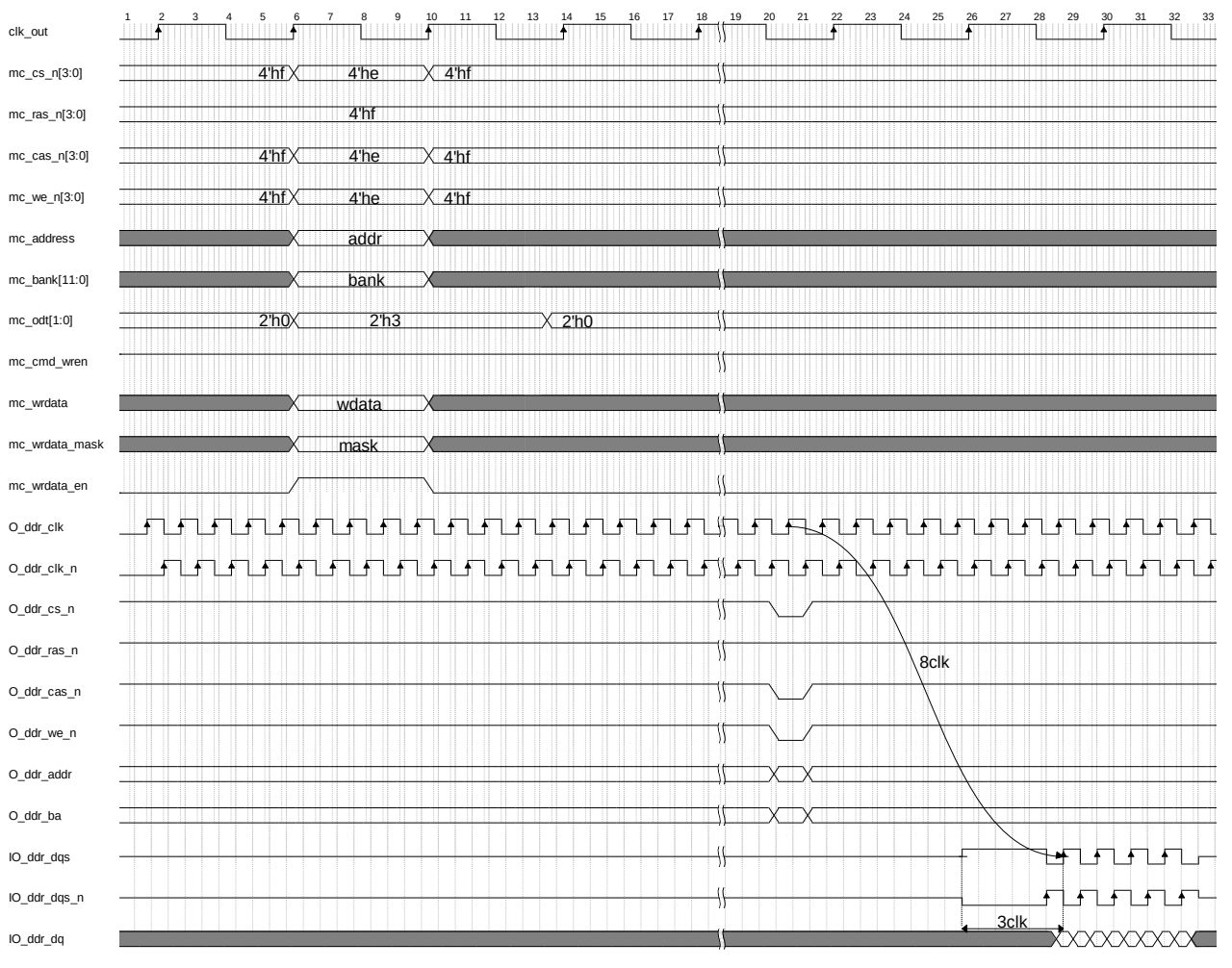
図 3-9 CWL=8,AL=0 の場合におけるデータ書き込みタイミング図
