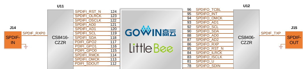
図 3-5 SPDIF インターフェースの接続図
