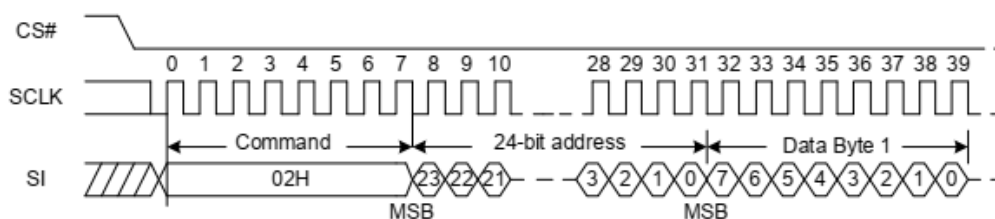
図 3-24 SPI Flash の書き込みタイミング
